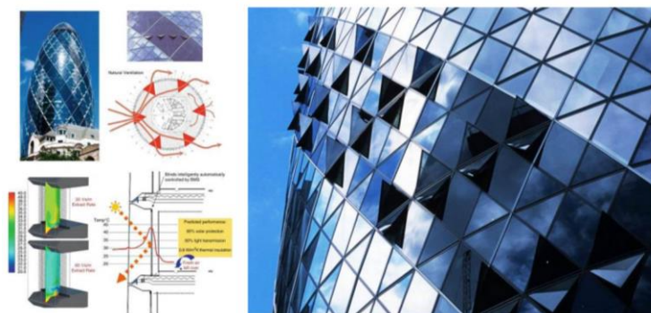
شکل ۳- سیستم تهویه طبیعی با طراحی پنجره های دوجداره در برج گرکین لندن
