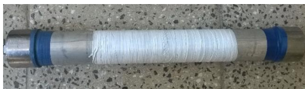
Fig. 25 The test result for tube filled with hydraulic oil using the three-piece die and teflon tape شکل 25 نتیجه آزمایش با روغن هیدرولیک با استفاده از قالب سه قطعه‌ای و نوار تفلون
