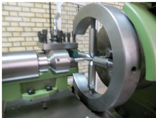
شکل 1 فرایند غلتک‌زنی عمیق آلومینیوم 7075
