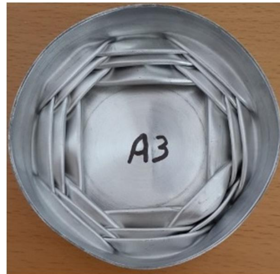
شکل 6 نمای پایین از فروریزش با مود الماسی و الگوی چهارضلعی‌های متوالی
