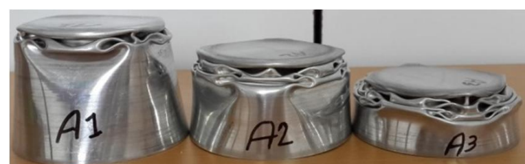
شکل 8 تأثیر جرم ضربه‌زن بر مقدار لهیدگی مخروط‌های گروه A
