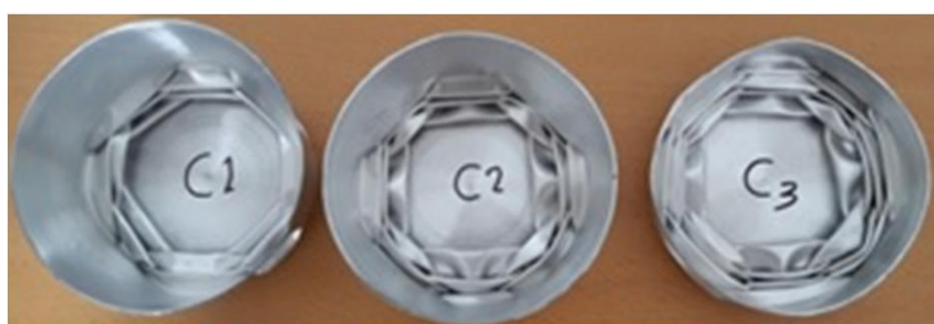
شکل 11 نمای پایین از مود فروریزش الماسی با الگوی چهارضلعی‌های متوالی برای مخروط‌های گروه C
