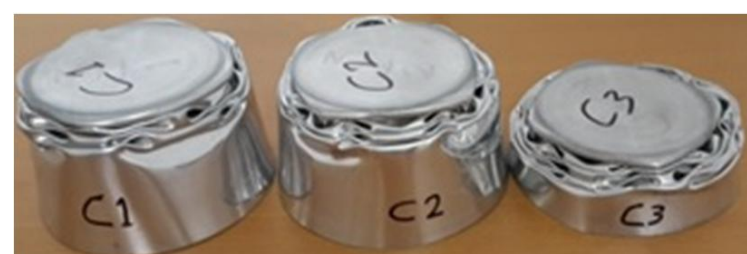
شکل 9 تأثیر جرم ضربه‌زن بر مقدار لهیدگی مخروط‌های گروه C
