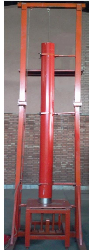
شکل 4 نمای کلی دستگاه ضربه‌زن سقوط آزاد
