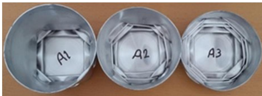
شکل 10 نمای پایین از مود فروریزش الماسی با الگوی چهارضلعی‌های متوالی برای مخروط‌های گروه A
