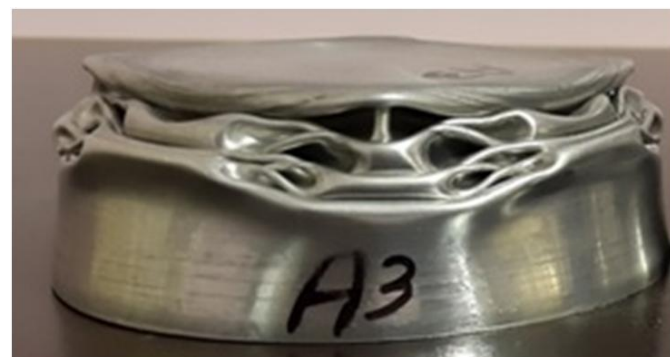
شکل 7 نمای روبرو از فروریزش با مود الماسی و الگوی چهارضلعی‌های متوالی
