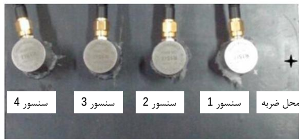
شکل 1 سامانه آزمایش: محل ضربه چیدمان سنسورها نسبت به هم
