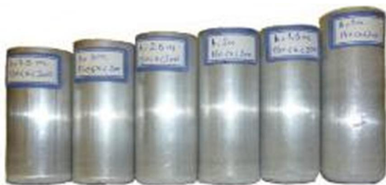
شکل 4 نمونه‌هایی از قطعات تولیدشده از پودر آلومینیوم با فرآیند تراکم پودر
