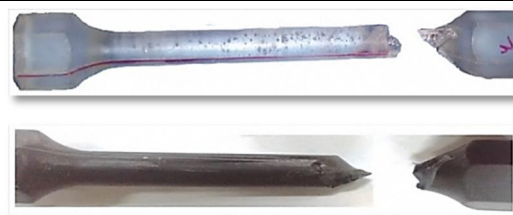
شکل 5 نمونه آزمایش پیچش پس از شکست اپوکسی خالص (تصویر بالا) و اپوکسی تقویت شده با 0/25 درصد نانوالیاف کربن (تصویر پایین)
