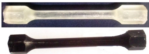
شکل 2 نمونه پیچشی اپوکسی خالص (تصویر بالا) و اپوکسی تقویت شده با 0/25 درصد نانوالیاف کربن (تصویر پایین)
