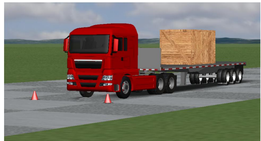
شکل 6 نمایی از خودروی مفصلی با بار صلب در مانور تعویض خط دوگانه
