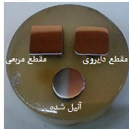
شکل 6 نمونه‌های مانت شده ماده اولیه آبیل شده و مقطع مربعی و دایروی ECAP شده
