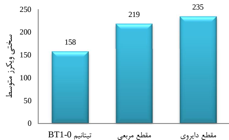
شکل 26 مقایسه سختی ویکرز ماده اولیه و ECAP شده با مقطع مربعی و دایروی
