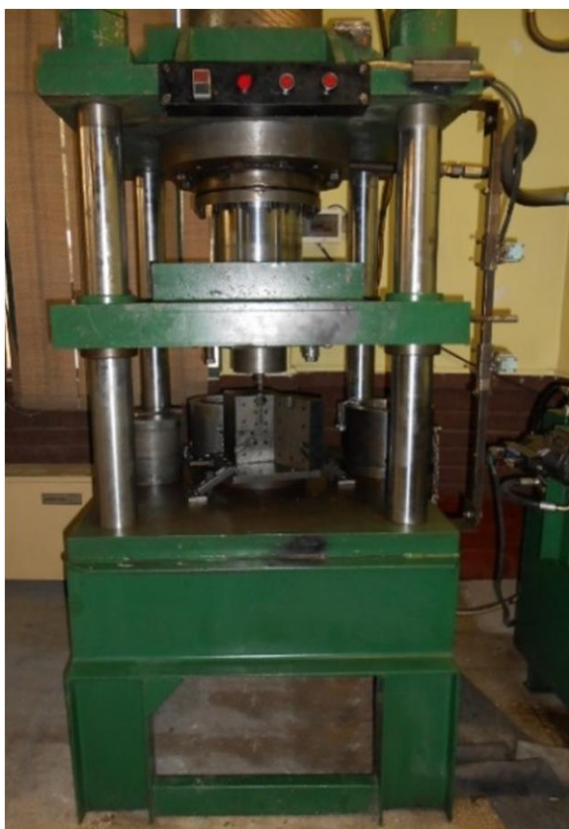
شکل 4 پرس هیدرولیک 200 تن مورد استفاده
