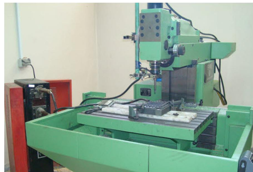
شکل 3 مجموعه‌ی مورد استفاده برای شکل‌دهی نموی گرم الکتریکی ورق
