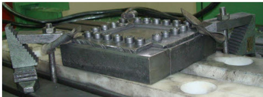
شکل 5 فیکسچر ساخته شده برای شکل‌دهی ورق Ti-6Al-4V
