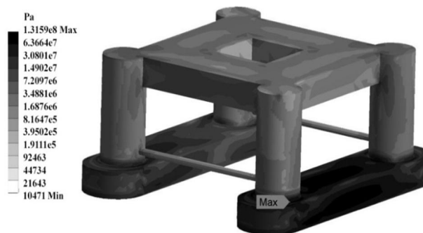
شکل 7 نمایی از توزیع تنش فون مایز در کل سکوی حفاری نیمه شناور امیرکبیر
