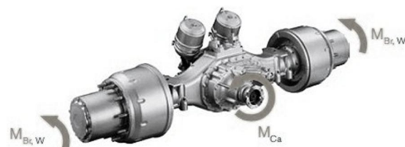
شکل 12 گشتاور ترمزی روی محور عقب خودرو
