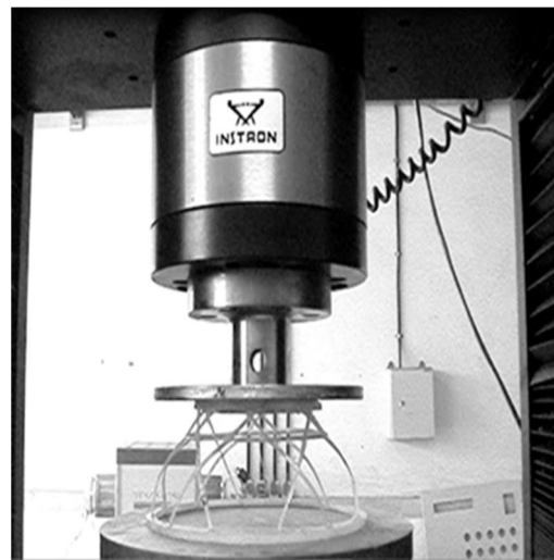
شکل 14 کمانش عمومی پوسته مشبک مخروطی در حین آزمایش
