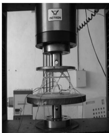
شکل 12 آزمایش فشار محوری پوسته مشبک مخروطی
