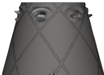
شکل 7 کمانش موضعی در پوسته خارجی
