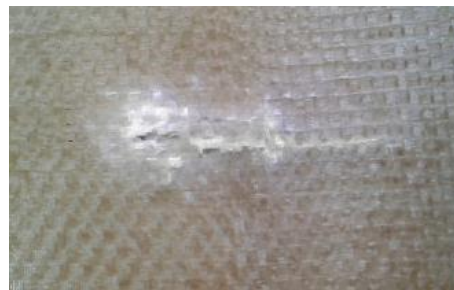
شکل ۱۵ اثر کشیده شدن تیزی پرتابه بر لایه‌های جلویی هدف بر اثر انحراف پرتابه قبل از ورود به هدف (آزمایش Ot-7)
