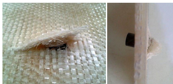
شکل ۸ نفوذ پرتابه با دماغه تخت در هدف کامپوزیتی (آزمایش B-2)
