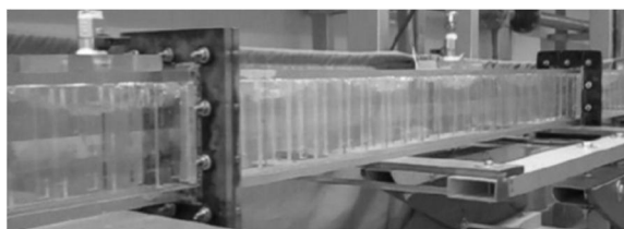
شکل 11 رژیم پلاگ برای u_0 = 4\text{m/s} , u_1 = 0.8\text{m/s}
