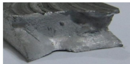
شکل 15 سطح مقطع شکست نمونه 5
