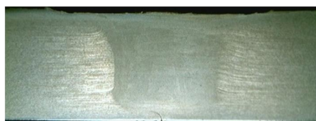
شکل 7 مقطع جوش برای ابزار با شانه 26 میلی‌متر
