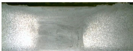
شکل 6 مقطع جوش برای ابزار با شانه 20 میلی‌متر
