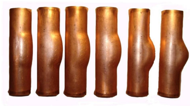
شکل 5 لوله‌های تغییر شکل یافته در آزمایش بالچ
