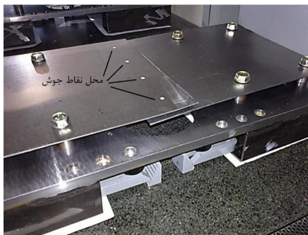
شکل 8 نمایش مجموعه مورد آزمایش به همراه فاصله بین ورق‌ها و نقاط اتصال
