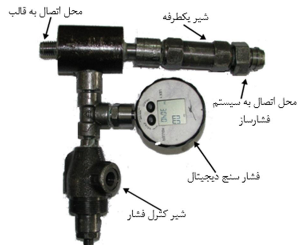
شکل 7 تجهیزات سیستم هیدرولیک کنترل فشار
