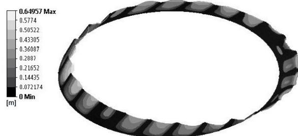
شکل 16 کانتور کرنش در حلقه الاستیک
