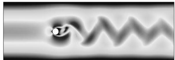
شکل ۳ کانتور جریان و گردابه‌های ایجاد شده در پشت سیلندر اصلی در حالت عدم وجود سیلندر کنترلی در Re=200 t=100s
