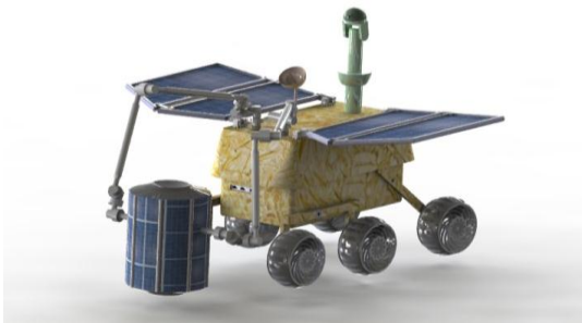
شکل ۲ نمایش سیستم ربات فضانورد مفروض شامل دو صفحه خورشیدی انعطاف‌پذیر
