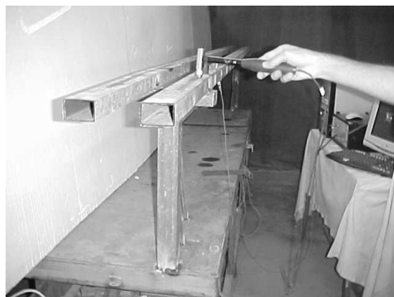
شکل ۸ پل تحت آزمایش مودال کلاسیک
