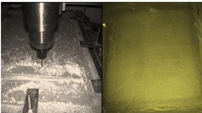
شکل ۲ چندلایه پخت‌شده (راست) و برش کاری نمونه‌ها برای آزمون کشش توسط دستگاه CNC (چپ)
