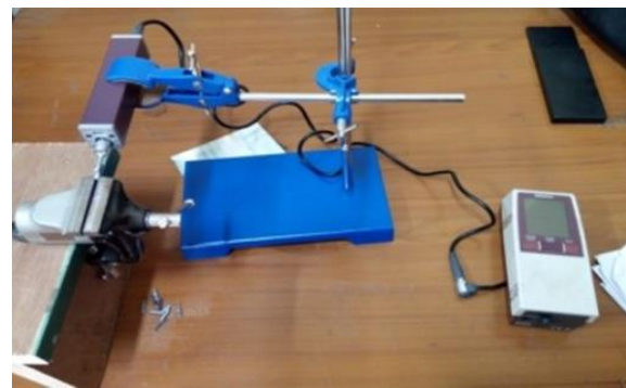
شکل (۲) زبری سنج (SJ-210) Mitutoyomake
