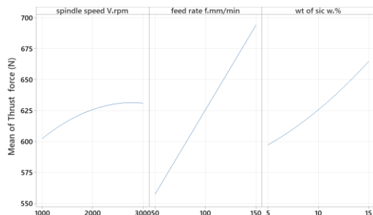
شکل ۵) اثر پارامترهای ورودی بر روی رفتار نیروی محوری
