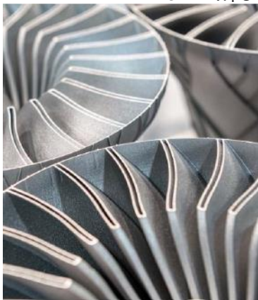
شکل ۲) پروانه فلزی ساخته شده با فناوری ساخت افزایشی
