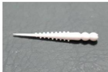
شکل ۹) نمایی از پین‌جت تولیدشده از جنس HIPS 7240
