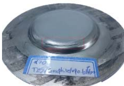
شکل ۹) ترک پیش‌رونده پدیدار شده در سطح قطعه (آزمون در زاویه دیواره ۷۰ درجه، دمای ۲۵۰ درجه سانتی‌گراد، گام عمودی ۰/۶ میلی‌متر، سرعت پیش‌روی ۶۰۰ میلی‌متر بر دقیقه و در حضور روانکار گرافیت صورت گرفته است)
