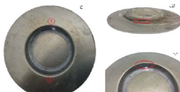
شکل ۱۲ الف) پارگی زودرس مشاهده‌شده در ناحیه نزدیک به فلنج در سطح خارجی ورق، ب) پارگی در ناحیه نزدیک به فلنج در سطح داخلی ورق، ج) کشیدگی ورق به یک سمت و بروز پارگی در ناحیه شماره ۱ (آزمون در زاویه دیواره ۶۰ درجه، دمای ۴۰۰ درجه سانتی‌گراد، گام عمودی ۶/۰ میلی‌متر، سرعت پیش‌روی ۶۰۰ میلی‌متر بر دقیقه و در حضور روانکار گرافیت صورت گرفته است)
