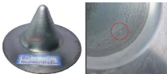
شکل ۱۰) ترک پایدار مشاهده‌شده در سطح داخلی و بیرونی قطعه (آزمون در زاویه دیواره ۶۰ درجه، دمای ۴۰۰ درجه سانتی‌گراد، گام عمودی ۰/۶ میلی‌متر، سرعت پیش‌روی ۶۰۰ میلی‌متر بر دقیقه و در حضور روانکار مولیبدن‌دی‌سولفید صورت گرفته است)
