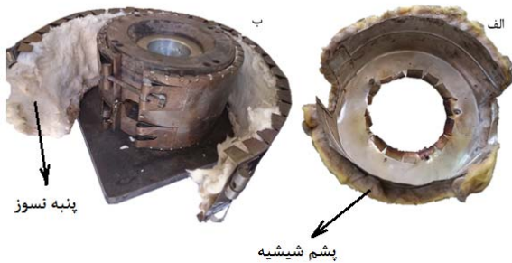
شکل ۶ (الف) عایق پشم شیشه (عایق بیرونی)، (ب) عایق پنبه‌نسوز مورد استفاده در قالب (عایق داخلی)
