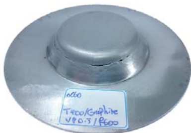
شکل ۱۷) نمونه شکل‌داده‌شده در زاویه ۶۰ درجه، دمای ۴۰۰ درجه سانتی‌گراد، سرعت پیش‌روی ۱۰۰ میلی‌متر بر دقیقه، با استفاده از روانکار پودر گرافیت در گام عمودی ۳/۰ میلی‌متر
