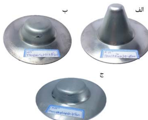
شکل ۱۶) نمونه‌های شکل‌داده‌شده در زاویه ۶۰ درجه، دمای ۴۰۰ درجه سانتی‌گراد، گام عمودی ۶/۰ میلی‌متر، سرعت پیش‌روی ۱۰۰ میلی‌متر بر دقیقه با استفاده از روانکار: الف) آنتی‌سبز بر پایه مس، ب) مولیبدن‌دی‌سولفید، ج) گرافیت
