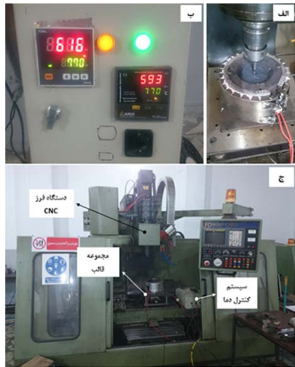
شکل ۳ (الف) مجموعه قالب، (ب) نمایشگر کنترلر دمایی مربوط به هر المنت سوار بر مدار کنترل دما، (ج) دستگاه فرز cnc
