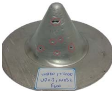
شکل ۱۸) عیوب مختلف مشاهده شده در شکل‌دهی ورق در زاویه ۶۰ درجه، دمای ۴۰۰ درجه سانتی‌گراد، گام عمودی ۳/۰ میلی‌متر، سرعت پیش‌روی ۱۰۰ میلی‌متر بر دقیقه با استفاده از روانکار مولیبدن‌دی‌سولفید
