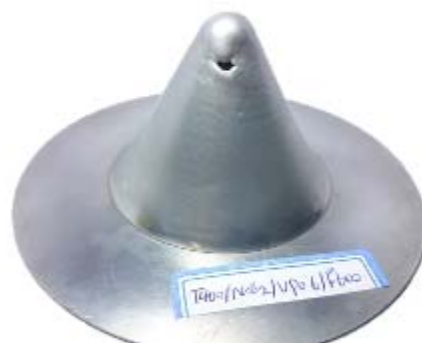
شکل ۱۱ ترک پایدار مشاهده‌شده در سطح داخلی و بیرونی قطعه (آزمون در زاویه دیواره ۶۰ درجه، دمای ۴۰۰ درجه سانتی‌گراد، گام عمودی ۶/۰ میلی‌متر، سرعت پیش‌روی ۶۰۰ میلی‌متر بر دقیقه و در حضور روانکار گرافیت صورت گرفته است)
