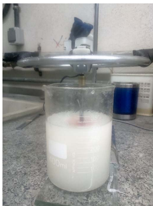
شکل ۱ روش سنتز کامپوزیت پلی‌سولفون/شیشه ۵۸S: خمیر کامپوزیت در حال هم‌زدن
