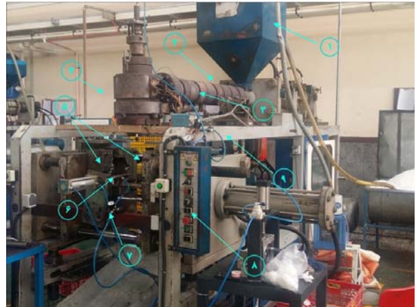
شکل ۳) ۱- مواد کش، ۲- سیلندر، ۳- المنت‌های حرارتی، ۴- کلگی دستگاه، ۵- دو نیمه قالب، ۶- پین باد، ۷- رگلاتور تنظیم فشار باد، ۸- مدار فرمان، ۹- چارچوب ماشین
