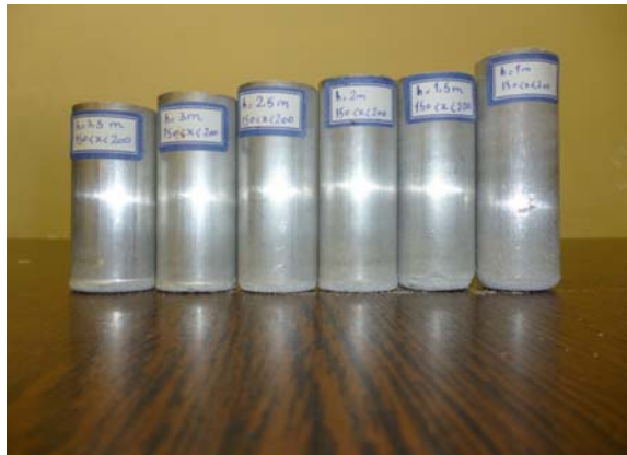
شکل ۳) قطعات تولیدشده از پودر آلومینیوم با روش تراکم پودر
