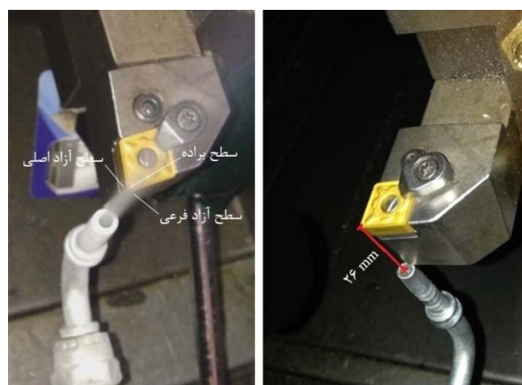
شکل ۵) روش Down در آزمون‌های ۷، ۸ و ۹؛ موقعیت قرارگیری نازل (تصویر راست) و نواحی که تحت پاشش سیال قرار می‌گیرند (تصویر چپ).
