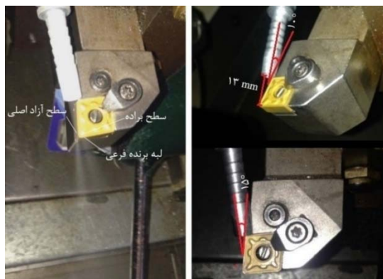
شکل ۴) روش Up2 در آزمون‌های ۴، ۵ و ۶؛ موقعیت قرارگیری نازل (تصویر راست) و نواحی که تحت پاشش سیال قرار می‌گیرند (تصویر چپ).
