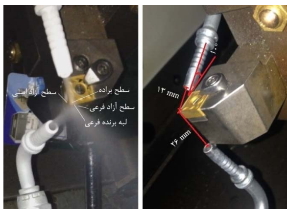
شکل ۷) روش Down-Up2 در آزمون‌های ۱۳، ۱۴ و ۱۵؛ موقعیت قرارگیری نازل‌ها (تصویر راست) و نواحی که تحت پاشش سیال قرار می‌گیرند (تصویر چپ).
