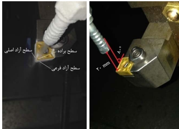
شکل ۳) روش Up1 در آزمون‌های ۱، ۲ و ۳؛ موقعیت قرارگیری نازل (تصویر راست) و نواحی که تحت پاشش سیال قرار می‌گیرند (تصویر چپ)
