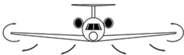
شکل (۲) گردابه‌های نوک بال در فاصله نزدیک سطح
