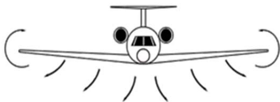
شکل (۱) گردابه‌های نوک بال در فاصله دور از سطح
