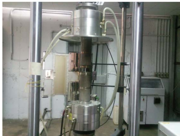
شکل (۵) دستگاه Instron8800 مورد استفاده برای اجرای آزمایش خستگی کرنش کنترل
