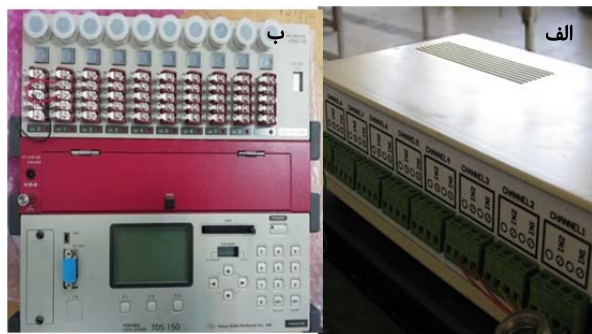
شکل ۳ (الف) دستگاه ثبت داده؛ (ب) دستگاه ثبت داده استفاده‌شده در تحقیق حاضر، (ب) دستگاه ثبت داده TDS-150 استفاده‌شده برای کالیبره کردن
