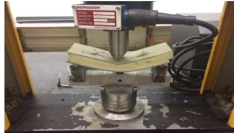
شکل (۳) یکی از نمونه ساندویچ پانل‌ها حین بارگذاری خمشی
