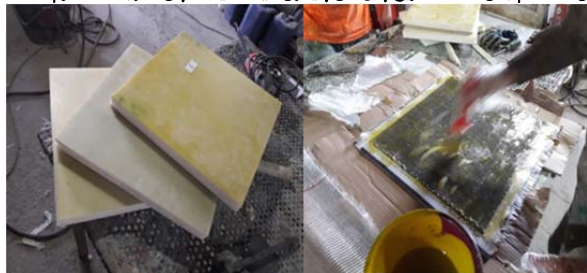
شکل (۱) نمای کلی ساندویچ پانل‌ها به همراه فرآیند ساخت
