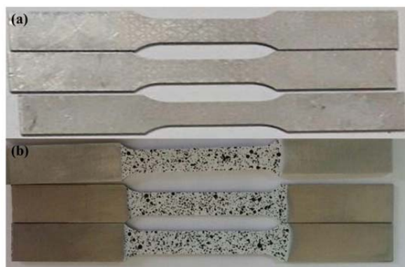
شکل ۳ (a) قبل، (b) بعد از آماده‌سازی سطحی نمونه‌های آزمون کشش قبل و بعد از آماده‌سازی سطحی؛ (a) قبل، (b) بعد از آماده‌سازی سطحی
