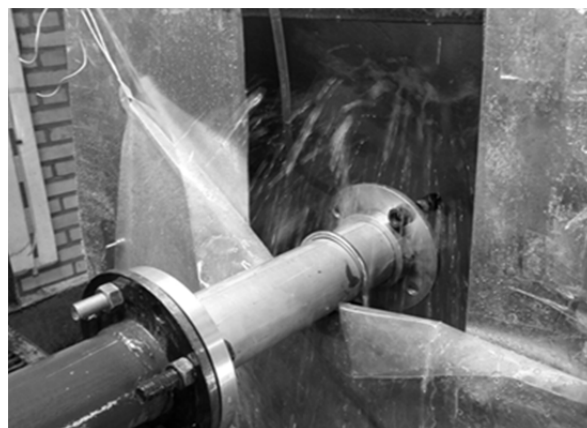
شکل ۱۰) توربین ساخته‌شده و در حال آزمایش
