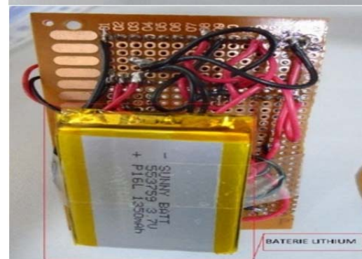
شکل ۱) نماهای متفاوت از مازول ساخته‌شده برای ناوبری یک عابر پیاده (الف) نمای جلویی مازول مونتاژشده؛ (ب) نمای بالایی مازول ناوبری؛ (ج) نمای پشتی مازول ساخته‌شده
