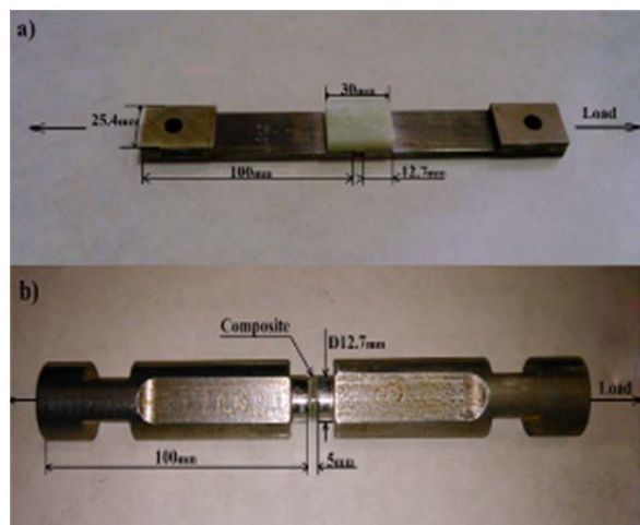
شکل ۱) تصاویر نمونه‌های مورد استفاده در آزمون‌های برش و کشش مطابق با استانداردهای ASTM: (a) آزمون برش، (b) آزمون کشش
