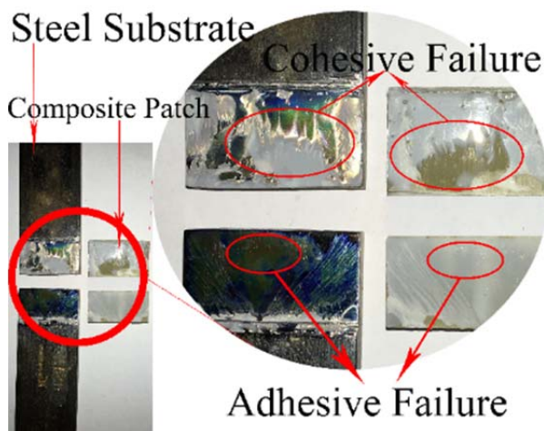
شکل ۵) تصاویر ماکروسکوپی از مقطع شکست کامپوزیت- فولاد
