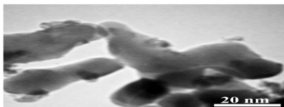
شکل ۱) تصویر TEM از مورفولوژی نانوذرات Al 2 O 3 مورد استفاده برای ایجاد پوشش نانوکامپوزیت
