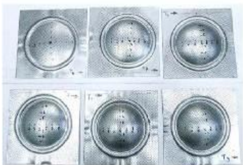
شکل 2 آزمایش بالچینگ یا فولاد استحاله مارتنزیتی، [10]
