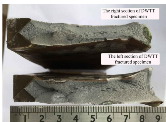
Fig. 9 Fracture surface of DWTT specimen with spiral seam weld شکل 9 سطح شکست نمونه آزمایش ضربه سقوطی حاوی درزجوش مارپیچ
