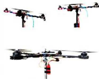
Fig. 14 Simulation model for quadrotor with three degree of freedom شکل 14 ساختار مدل شبیه‌ساز سه درجه آزادی
