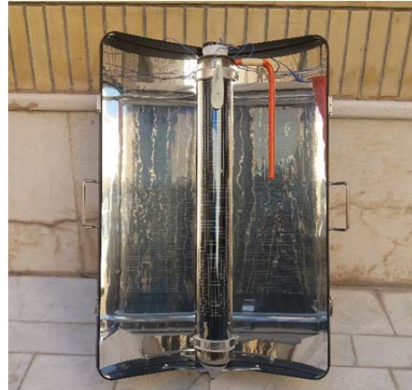
شکل ۲) نمایی از اجاق خورشیدی با لوله تحت خلأ همراه با مخزن فولادی
